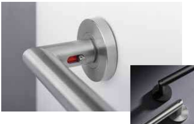
▲ Eurodrücker ProLock, Rosette rund, Edelstahl matt, Verriegelung im Drücker mit zusätzlicher Notentriegelung auf der Gegenseite
